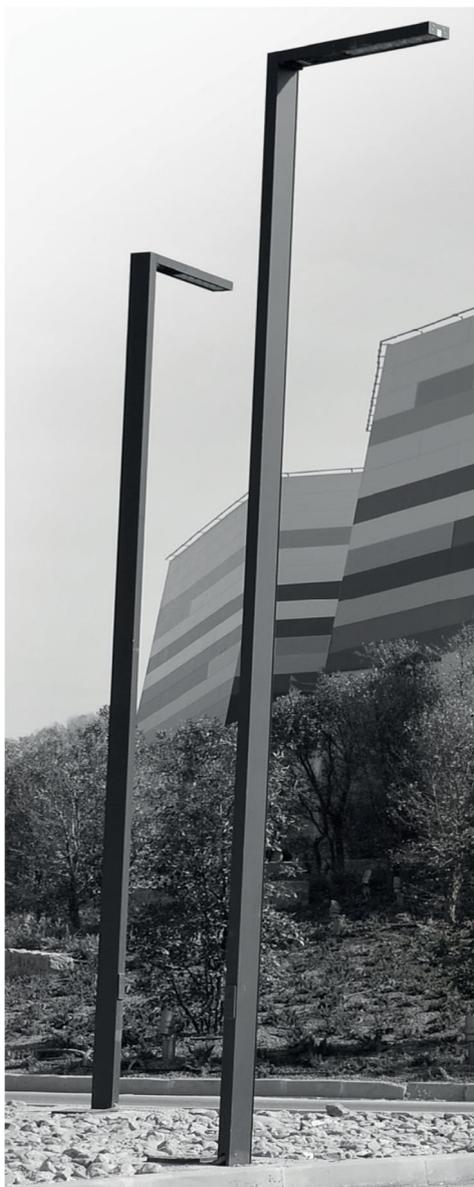
I pali di supporto degli apparecchi illuminanti saranno costituiti da trafilati in acciaio, a sezione quadrata cava, senza saldature, zincati a caldo sia internamente che esternamente, di dimensioni esterne 15x15 cm, con finitura a vernice epossidica disponibile in varie colorazioni.
